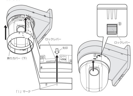
③ 飾りカバー(下)の穴に、ロックレバーが確実に挿入されていることを確認してください。
