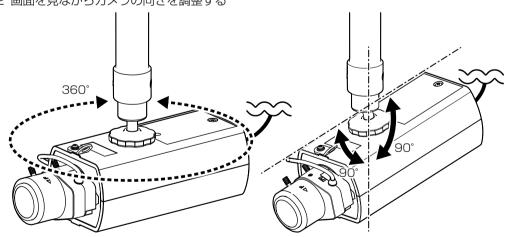
3 六角レンチで六角穴を回して可動部を固定する。 対辺3mm 六角レンチ(現地調達)
