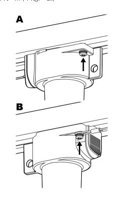
本金具をライティングレールへ固定後、カメラからの落下防止ワイヤーがレール内(通 電部)に接触していないことを必ずご確認ください。
