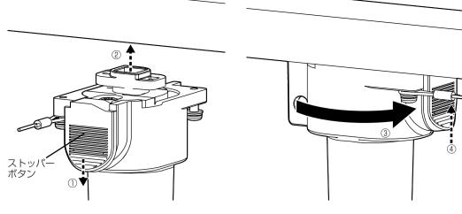
2 仮固定したねじ2本を締め、本金具をライティングレールに固定する 推奨締付トルク: 0.39 N·m {4 kgf·cm}
