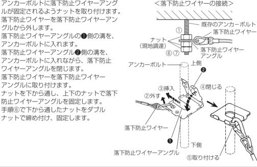
● 既存のアンカーボルトを使用して 落下防止ワイヤーを接続する場合、 中間挿入式ナットを2個使用すると 便利です。
