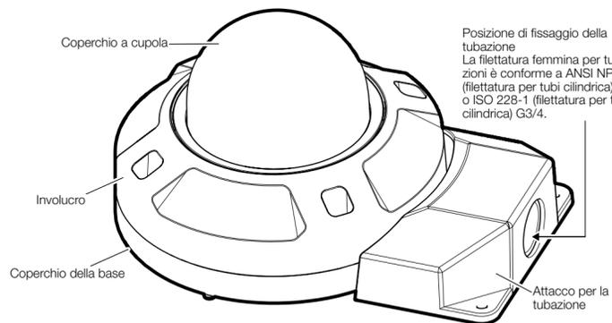
Posizione di fissaggio della tubazione
