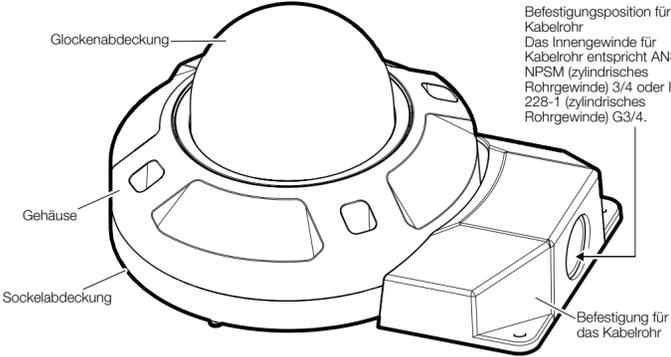
Befestigungsposition für Kabelrohr
