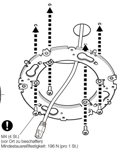
Wenn Sie die Einbaurichtung der Kamera nach der Installation ändern möchten.
