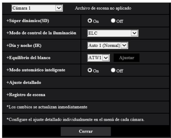
2. Haga clic en “+” de la parte izquierda de “Súper dinámico(SD)” para visualizar el menú detallado de SD.
