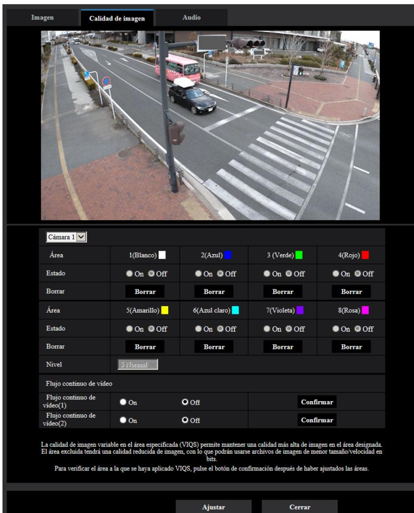
2. Configure el nivel de diferencia de calidad de imagen entre las áreas especificadas y las áreas no especificadas. Cuanto mayor sea el nivel de diferencia, más se reducirá la calidad de imagen del área no especificada. De este modo puede moderarse el tamaño de los datos de imagen.
