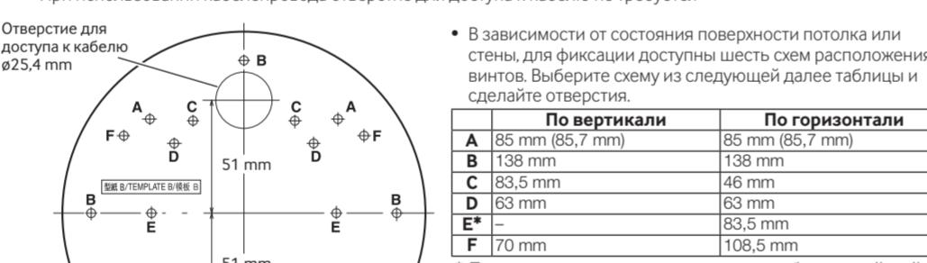
\* При установке на соединительную коробку с одной шайбой закрепите ее с помощью винтов (2 шт) (M4: приобретается на месте).
