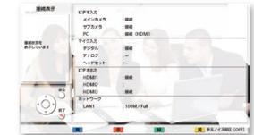
Quando há um problema com a ligação ou com um dos dispositivos conectados ou quando há um dispositivo que não está conectado, é apresentada a marca "—". Verifique que os dispositivos utilizados estão devidamente conectados à unidade principal e que a alimentação está ligada para todos os dispositivos conectados e que não mais do que 5 Microfones de Mesa (tipo de interface digital) estão conectados.
