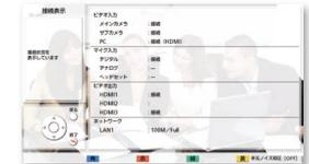
Se si verifica un problema con il collegamento o con uno dei dispositivi collegati, oppure se un dispositivo non è collegato, si visualizzerà il simbolo "—". Verificare che i dispositivi in uso siano collegati adeguatamente all'unità principale, che tutti i dispositivi collegati siano accesi e che non siano collegati più di 5 Microfoni perimetrali (tipo a interfaccia digitale).
