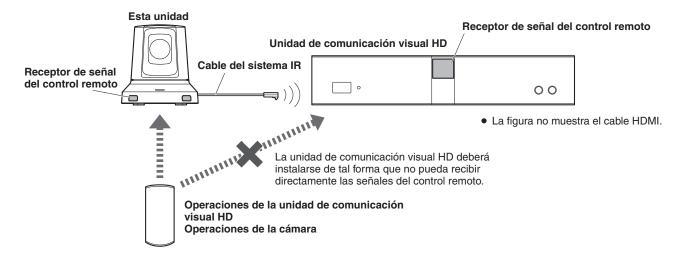
• Para conocer detalles sobre cómo conectar el cable del sistema IR (vendido por separado) y comprobar las operaciones después de haber instalado la unidad, consulte las páginas 17 y 18.
