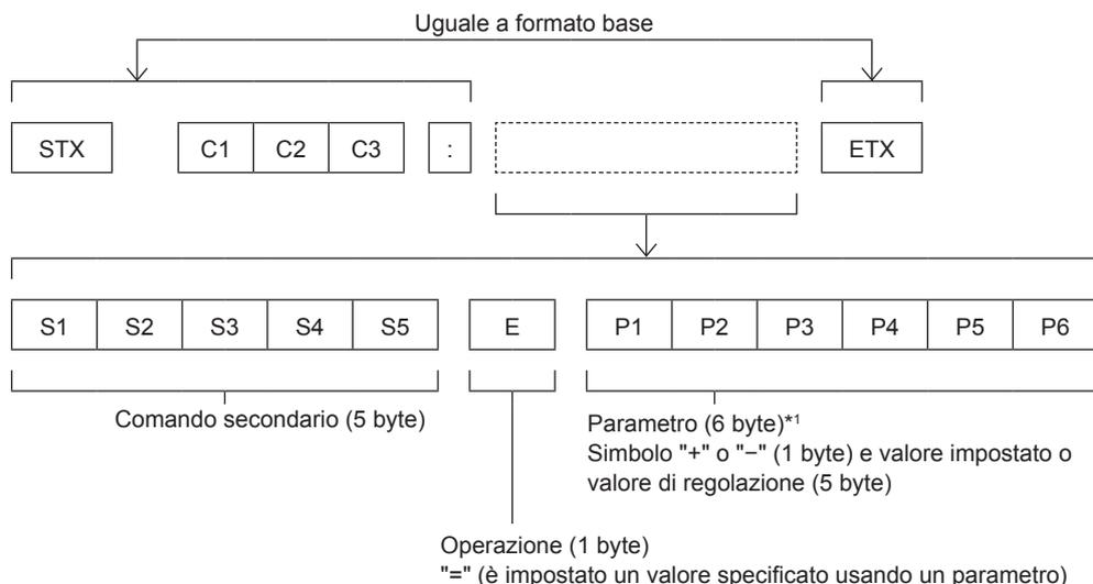
\*1 Quando si trasmette un comando che non ha bisogno di un parametro, l'operazione (E) e il parametro non sono necessari.
