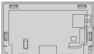
Posición para fijar el sensor IR externo
