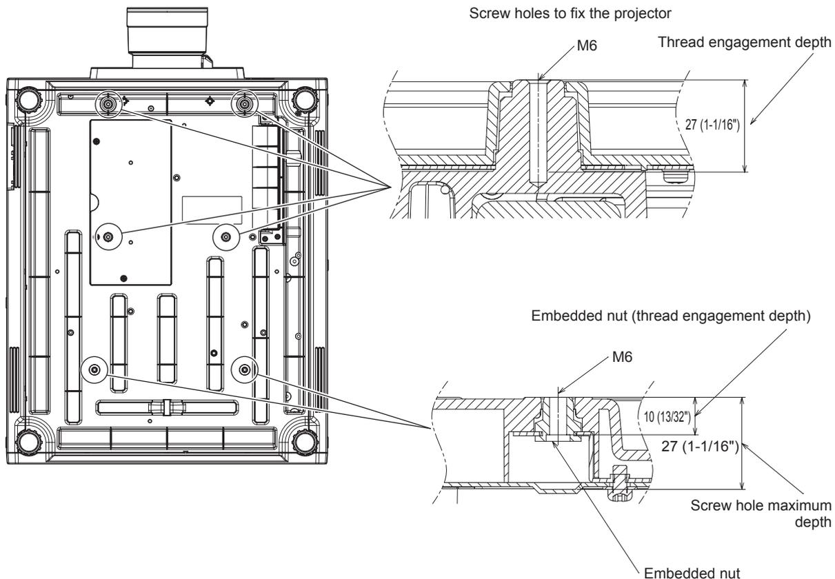
Screw tightening torque: (M6)  $4 \pm 0.5 \text{ N}\cdot\text{m}$
